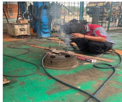
Gambar 5. Tahap fabrikasi rotary slasher
